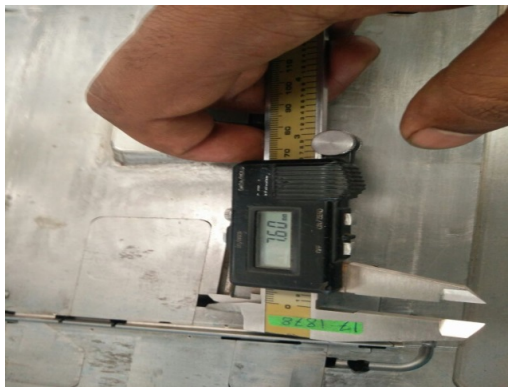
Fig. 5: Gate size 7.6 mm
