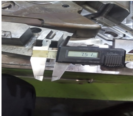
Fig. 4: Gate size 7.51 mm
